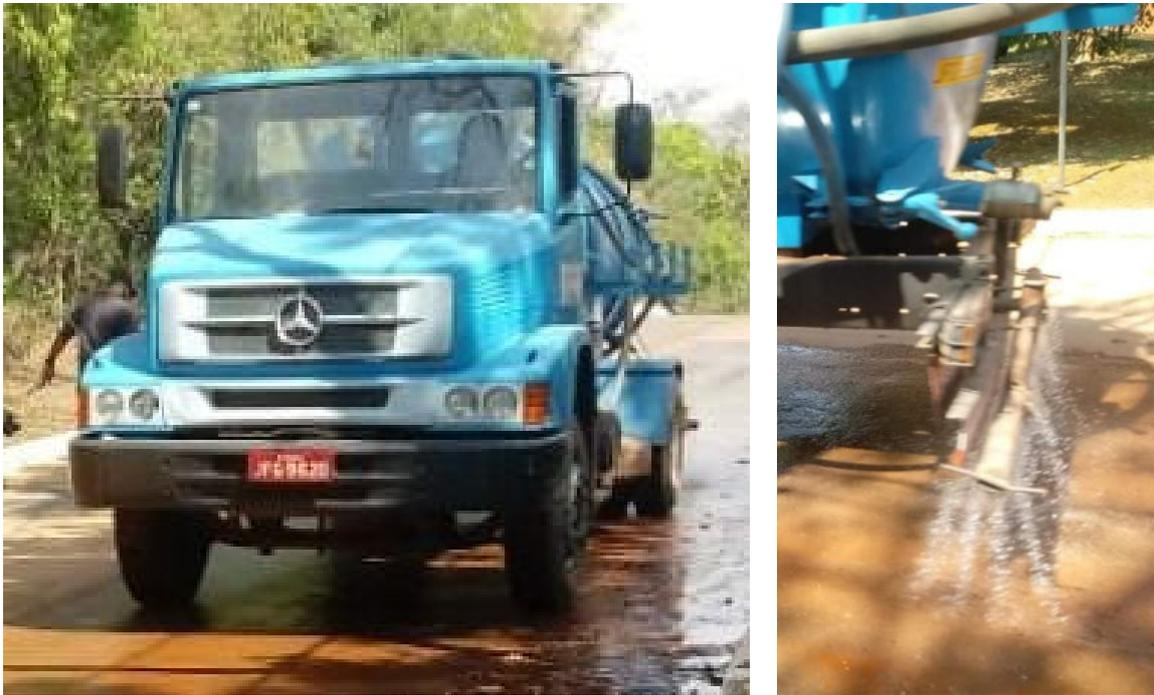
Figura 5 – Caminhão pipa usado.
